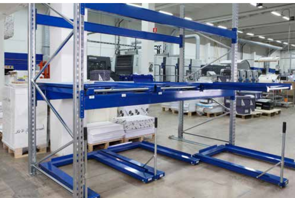
Urządzenie do wysuwania palet na podłodze i na belkach
