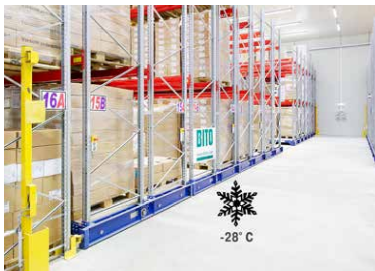
System mobilnych regałów paletowych w branży chłodniczej
