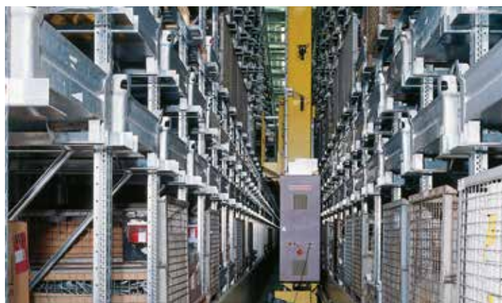
Zautomatyzowany regał paletowy w systemie jednomiejscowym
