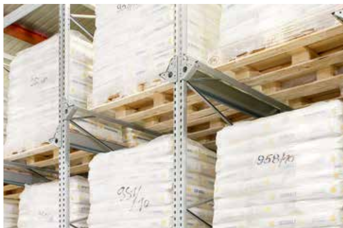
Paleta z przewisem towaru - Konsola zaczepowa zabezpieczona połączeniem śrubowym
