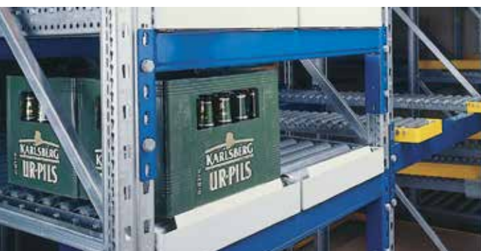
Sztywny profil ograniczający po stronie załadunku zapobiega cofaniu się ładunku - profil nachylony do przodu ułatwia załadunek
