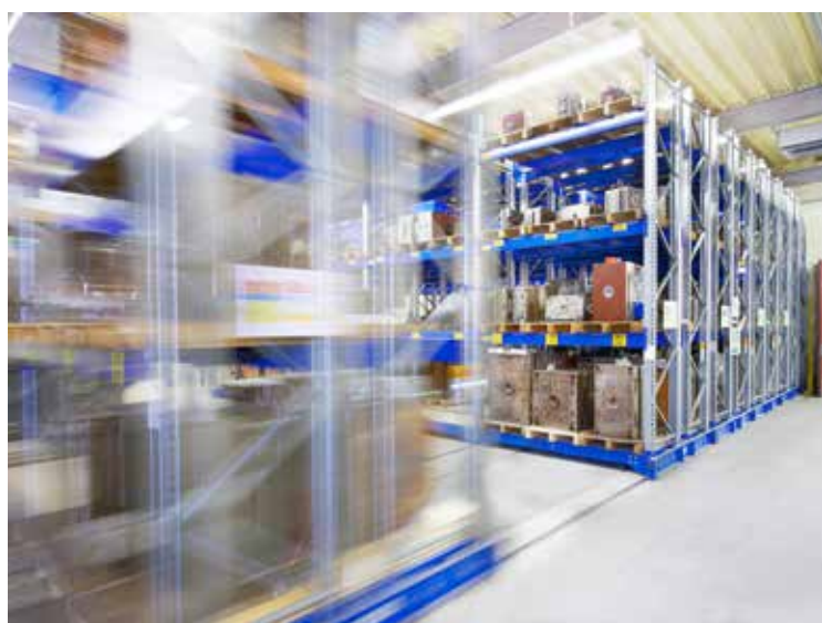
System mobilnych regałów paletowych
