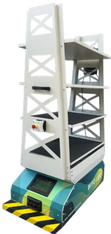
LEO carrier con estantería y una tableta montada para entrar el destino
