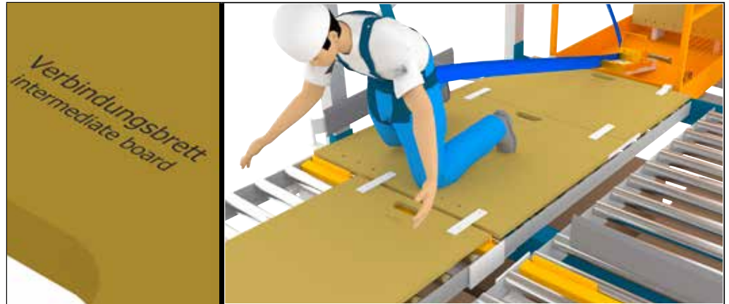
Bild 37: Sammankoppling av anslutningskiva och passkiva
