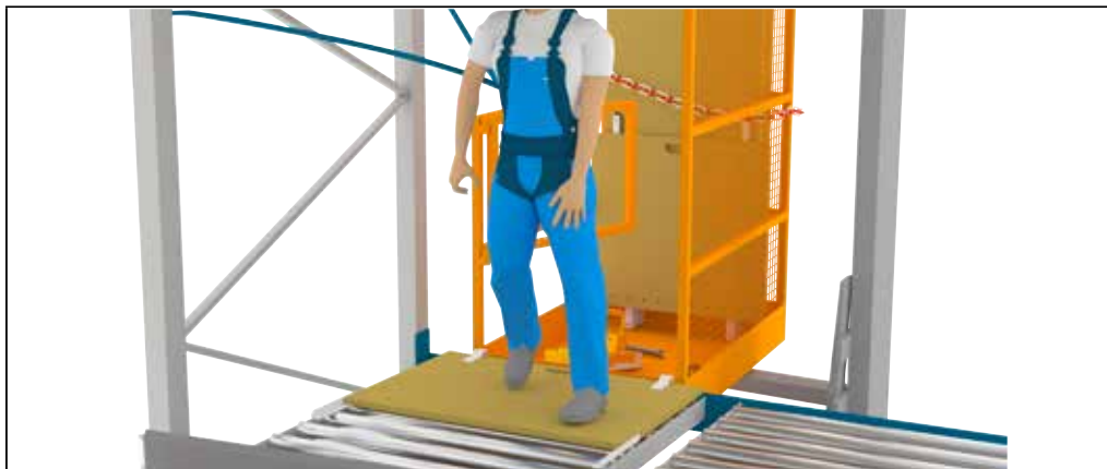
Bild 28: Uppstigning på startskivan från liften
