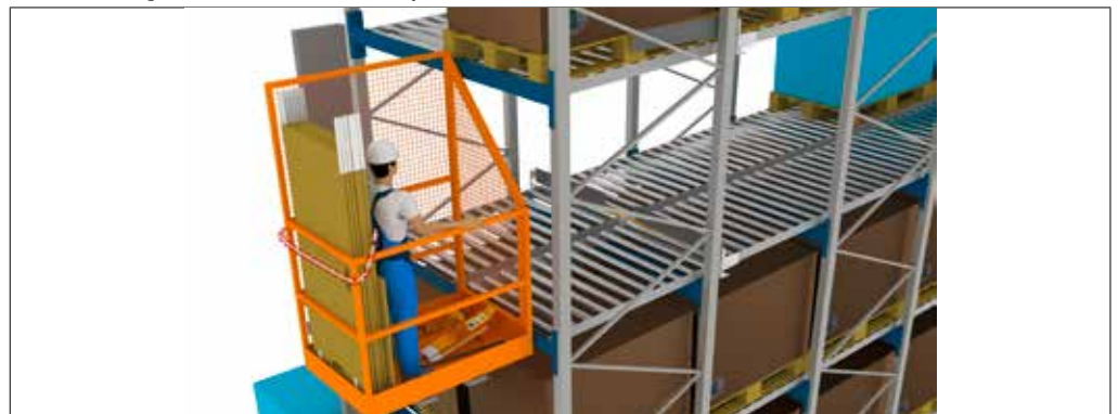
Bild 41: Gaffeltruck utan tillräckligt sidolyft (< 150 mm i varje riktning) och arbetsborg med avspärrning inom riskområdet
