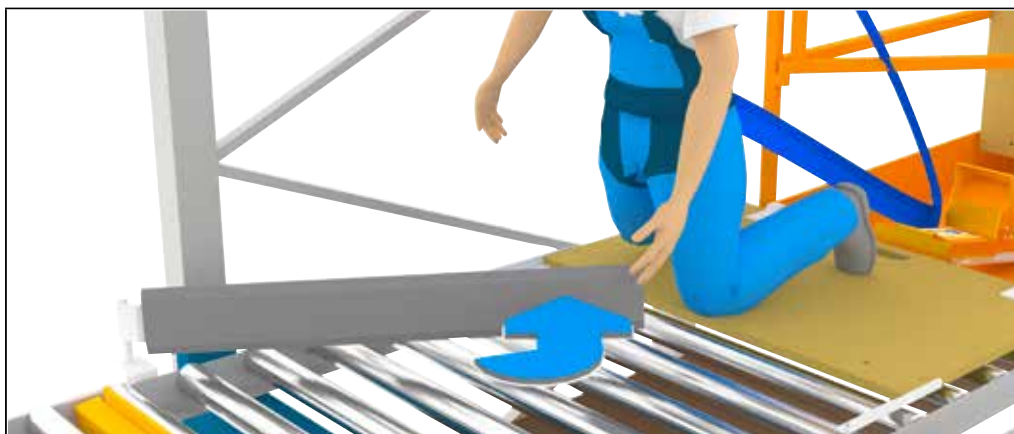
Bild 29: Vrid FlowStop-flaggan åt sidan.
