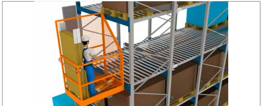
Kuva 41: Haarukkatrukki, jonka sivunostokorkeus ei ole riittävän suuri (< 150 mm kumpaankin suuntaan), ja henkilönostokori, jossa on aita vaara-alueen ympärillä.
