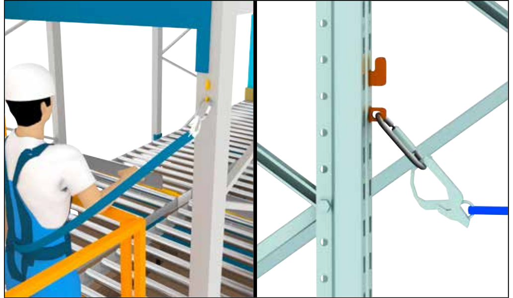
Kuva 25: BITOeasyHOOK-koukun kiinnittäminen pylvääseen.
