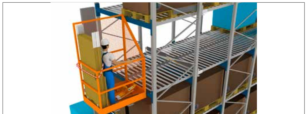
Illustratie 41: Vorkheftruck zonder voldoende zijlift (< 150 mm in elke richting) en werkkorf met hek in de gevarezone.
