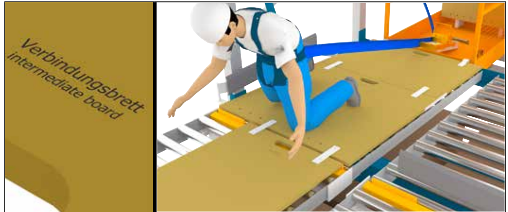
Illustratie 37: Verbind van de verbindingssplank met de passeerplank.
