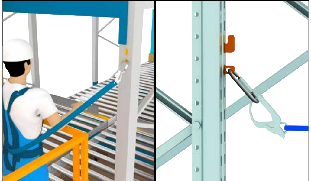
På billedet 25: Fastgørelse til stolpe ved hjælp af BITO-easyHook
