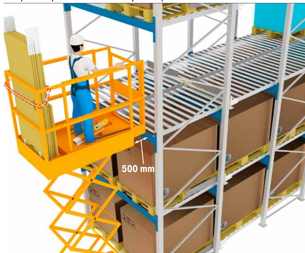
På billedet 42: Sakselift og yderligere arbejdsplatforme
