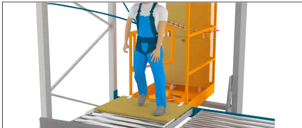
På billedet 28: Udtræden fra arbejdsplatformen til startbrættet for at kunne gå ind i nabokanalen
