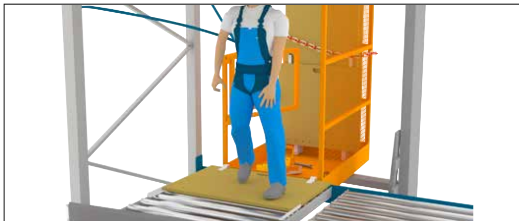
Figura 28: Paso de la plataforma de trabajo al tablero de entrada para facilitar el acceso
