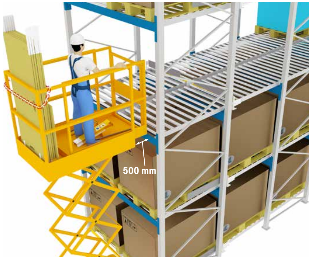
Figura 42: Plataforma elevadora de tijera y otras plataformas de trabajo
