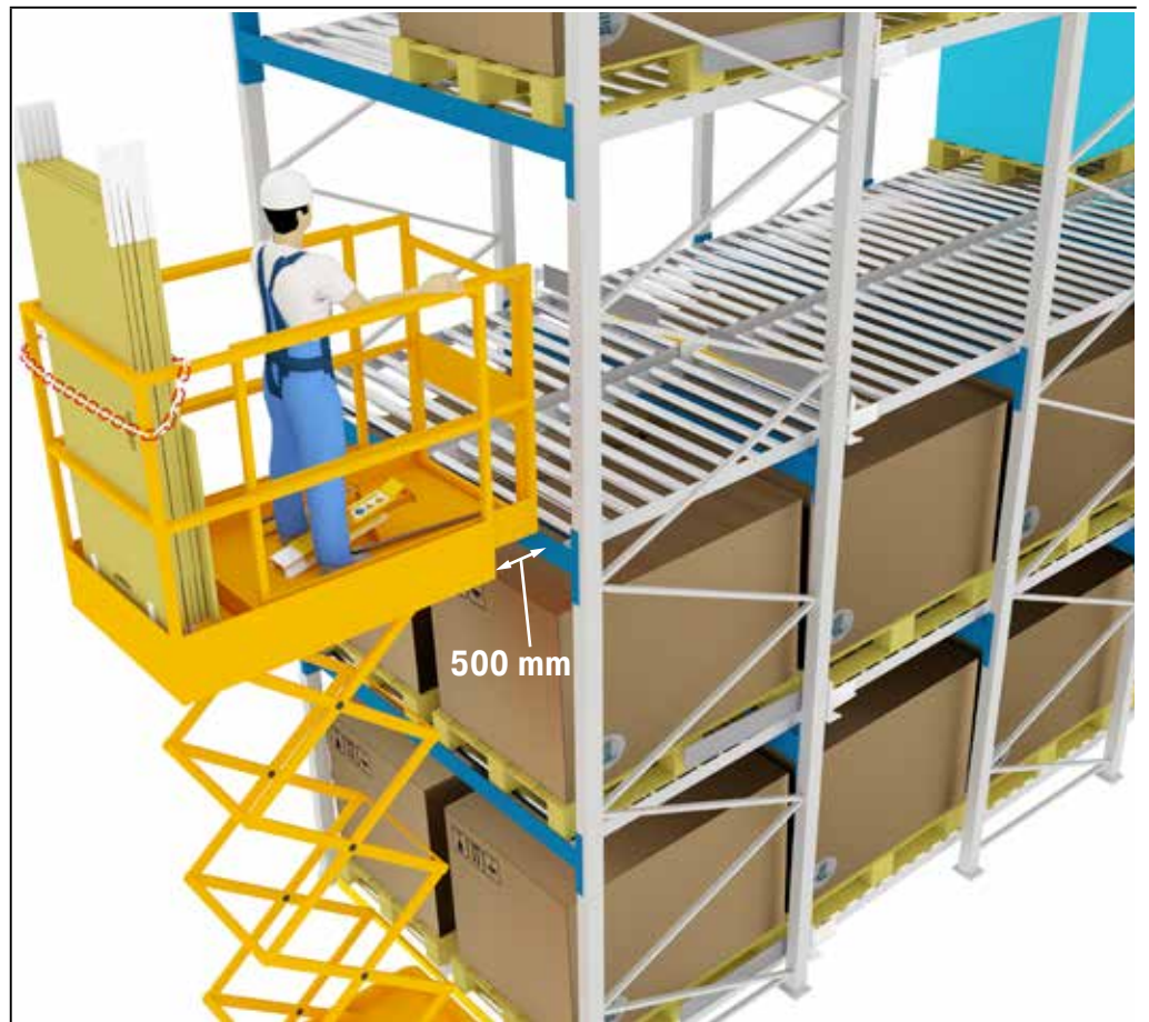
Figura 22: Plataforma elevadora de tijera y otras plataformas de trabajo
