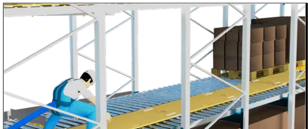
Figura 36: Colocar los tableros de unión hasta el punto del fallo.
