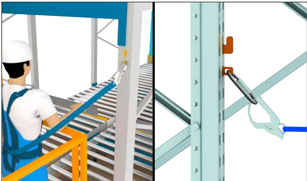
Figura 25: Sujeción al puntal con BITO easyHOOK
