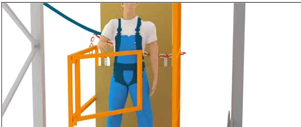
Figura 26: Apertura de puerta de la plataforma de trabajo
