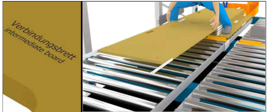
Figura 34: Colocar los tableros de unión
