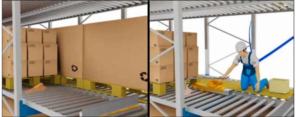
Abbildung 7: Entfernen von Gegenständen / Verpackungsresten im Kanal
