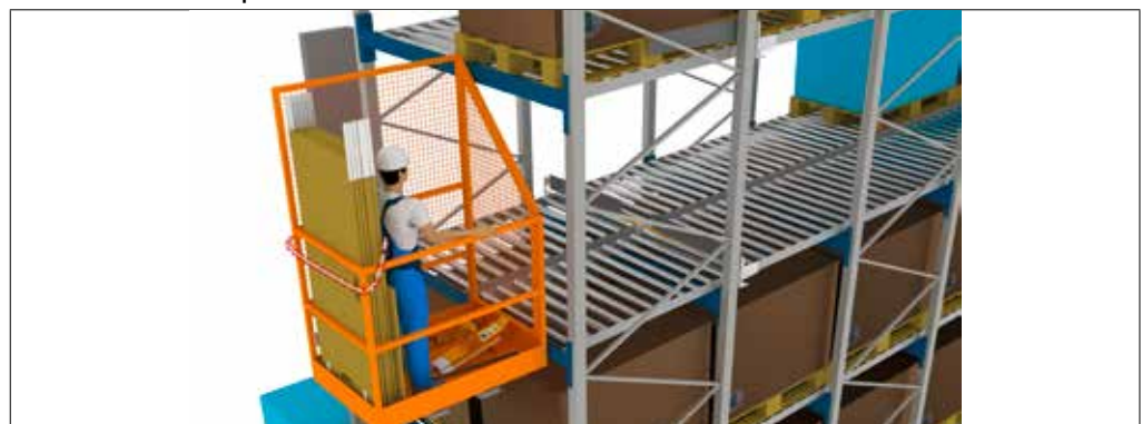
Abbildung 41: Gabelstapler ohne ausreichenden Seitenhub (< 150 mm je Richtung) und Wartungskorb mit Umzäunung im Gefahrenbereich
