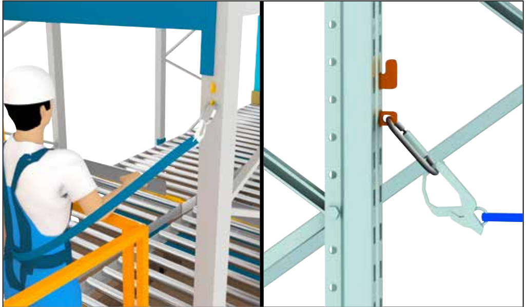
Abbildung 25: Sicherung mit BITO easyHook an Stütze
