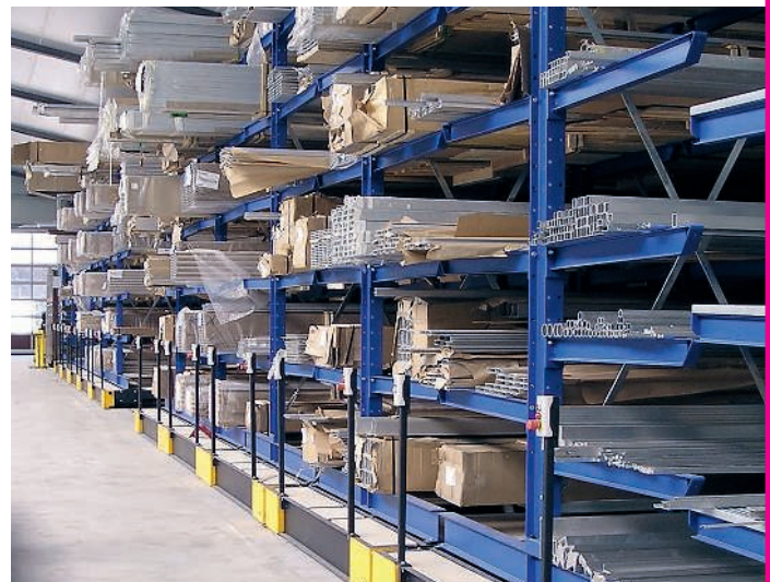
Kragarm-Verfahrregalanlage zur Langgutlagerung
